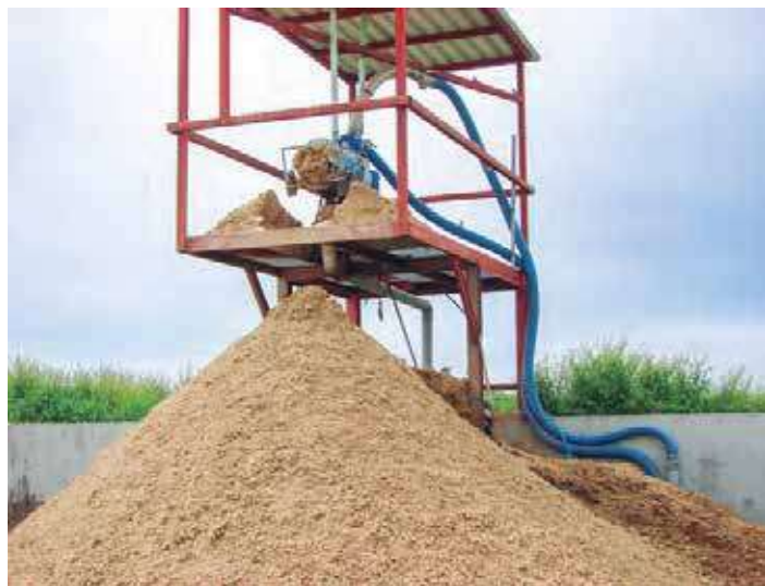
Figura 7. Separador mecánico sólido-líquido y sólido generado
